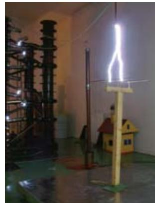
Имитирование атмосферных разрядов в модель воздушных линий в Лаборатории высоких напряжений Galmar
