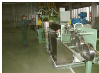
Линия для изготовления медной полосы
