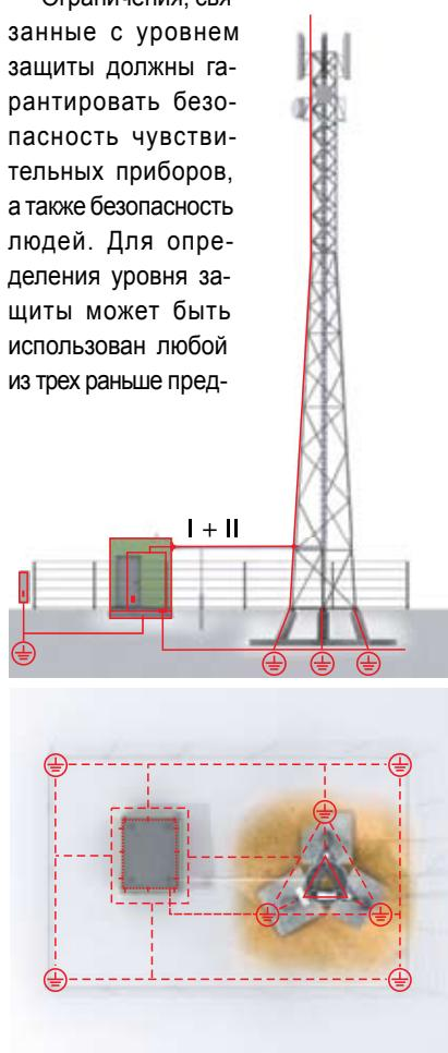
Рис. 13 Молниезащитная система металлических GSM башен
